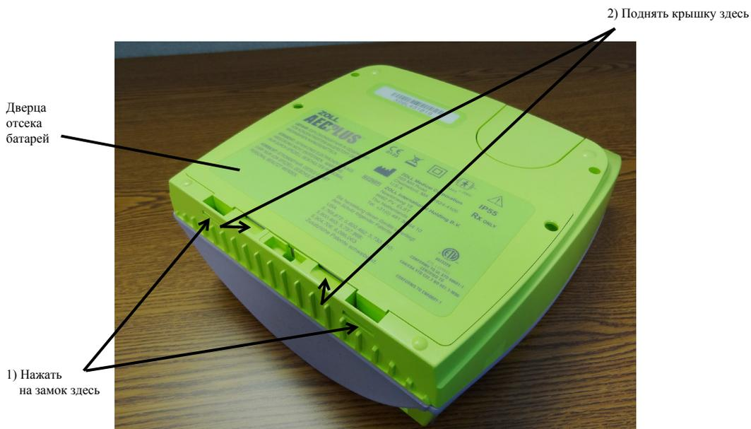
Рисунок 7: Снятие крышки отсека батарей
