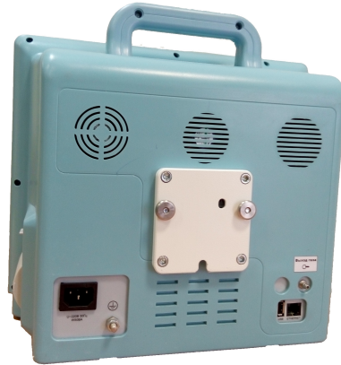
Рисунок 4.7 – Установка переходника быстрого крепления
