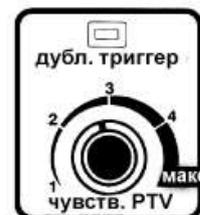
Однако, если установлена слишком низкая чувствительность или пациент не может сделать вдыхательное усилие во время временного окна поддержки, вентилятор будет подавать дыхание с резервной частотой и сообщит об этом индикатором «**ДУБЛ. ТРИГГЕР**». Если установлена слишком высокая чувствительность, аппарат ИВЛ может автоматически начать работать от случайного скачка давления.
