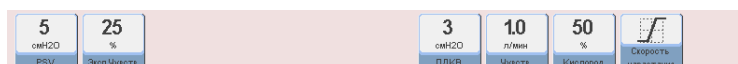
Рисунок 10-6 Программируемые параметры и их установки по умолчанию в режиме PSV/CPAP для новорождённых.
