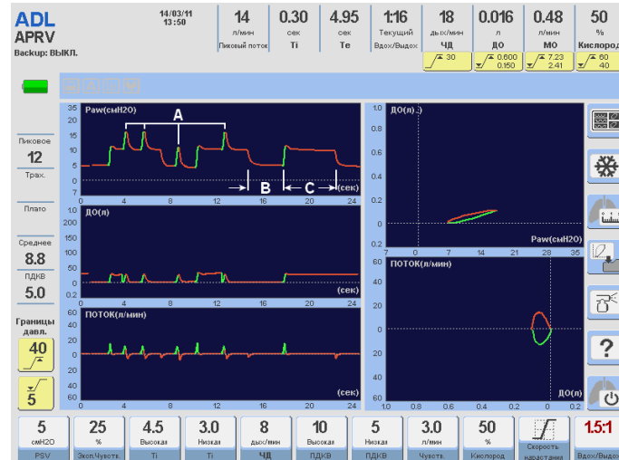
Рисунок 9-22 Иллюстрация экрана 5-ти графиков в режиме с двухфазным положительным давлением (APRV). А – спонтанное дыхание на верхнем и нижнем уровнях ПДКВ. В – нижний уровень ПДКВ и С – верхний уровень ПДКВ без спонтанного дыхания.
