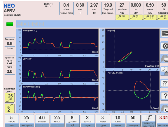
Рисунок 10-11 Иллюстрация экрана 5-ти графиков в режиме с двухфазным положительным давлением (APRV). Два первых спонтанных вдоха на верхнем уровне ПДКВ, а следующий – на нижнем.
