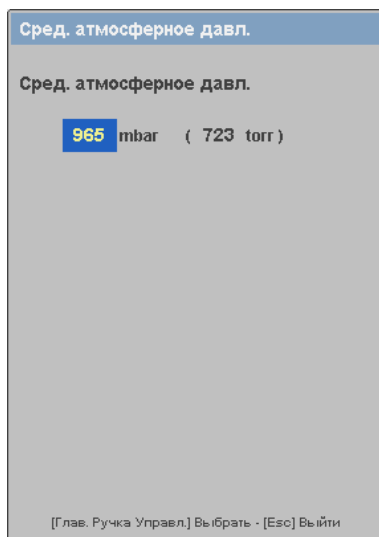
Рисунок 7-13 “СРЕДНЕЕ АТМОСФЕРНОЕ ДАВЛЕНИЕ” . В этом окне производится установка давления, соответствующего высоте над уровнем моря для того места, где находится аппарат.
