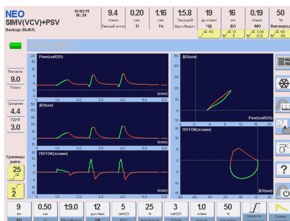
Рисунок 10-7 Режим SIMV (VCV) + PSV. Первый вдох выполненный в режиме VCV (принудительный или синхронизированный), сопровождается двумя спонтанными дыхательными циклами.
