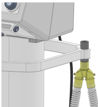
Рисунок 5-4 Иллюстрация блокировки тройника пациента с использованием приспособления на защитных перилах.
