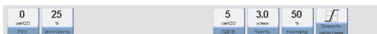
Рисунок 9-9 Программируемые параметры в режиме PSV/CPAP, характерные для СДППД (CPAP). За исключением уровня поддерживающего давления, остальные параметры идентичны параметрам режима PSV/CPAP.
