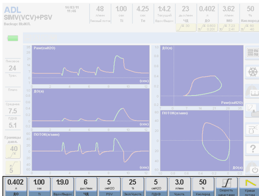
Рисунок 6-3 Изображение значений параметров ИВЛ в режиме СППВ (SIMV) с управляемым объёмом и поддержкой давлением (PSV).
