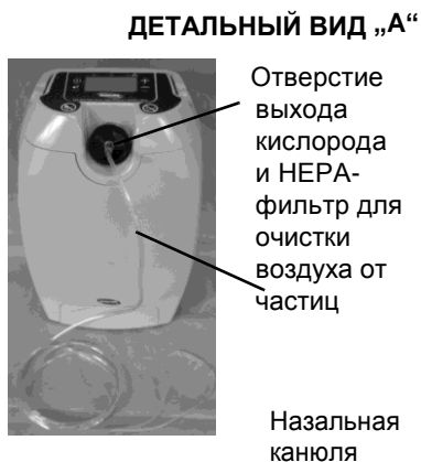
ИЗОБРАЖЕНИЕ 6.2 Присоединение/позиционирование назальной канюли
