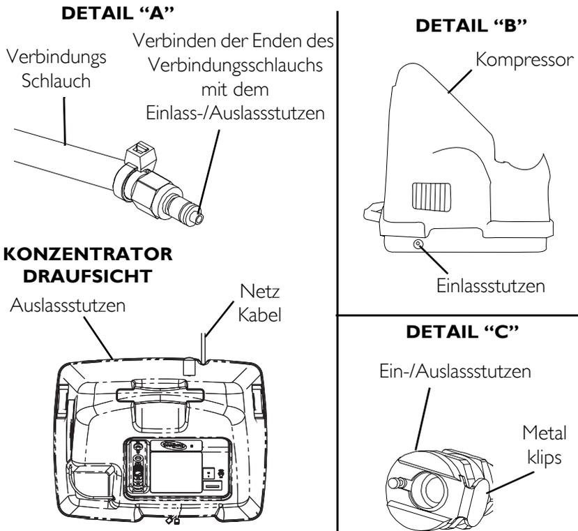
**ABBILDUNG 2.3** Verbinden des Kompressors an den Konzentrator
