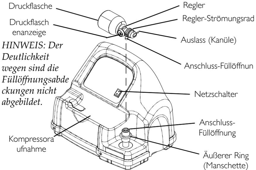
**ABBILDUNG 4.2** Anschließen der Druckflasche am Kompressor
