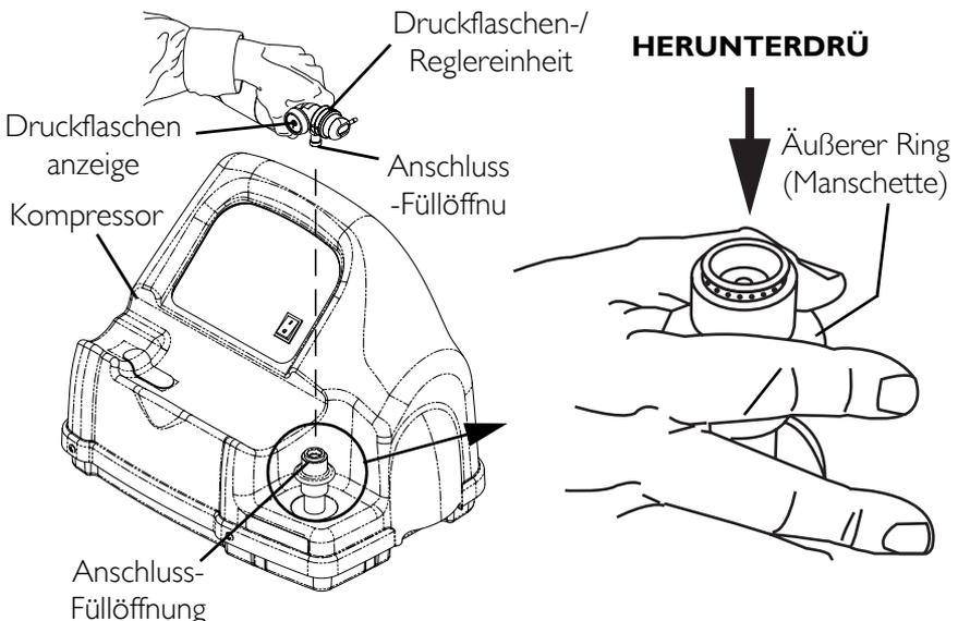
**ABBILDUNG 4.3** Trennen der Druckflasche vom Kompressor
